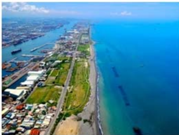
Figura 53 – Aspecto de una serie de espigones exentos, paralelos a la costa y sumergidos, en Cijin (Taiwan).
