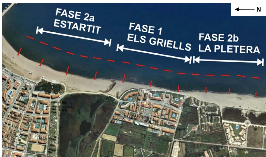
Figura 66 – Detalle de la propuesta de protección global de todo el frente litoral de l'Estartit, del dique de Garbí a La Pletera. Se indican las dos posibles soluciones a la vez (diques exentos y espigones perpendiculares) así como las dos fases constructivas propuestas. La primera, de Els Griells de carácter urgente, la segunda, de l'Estartit y La Pletera, prioritarias.
