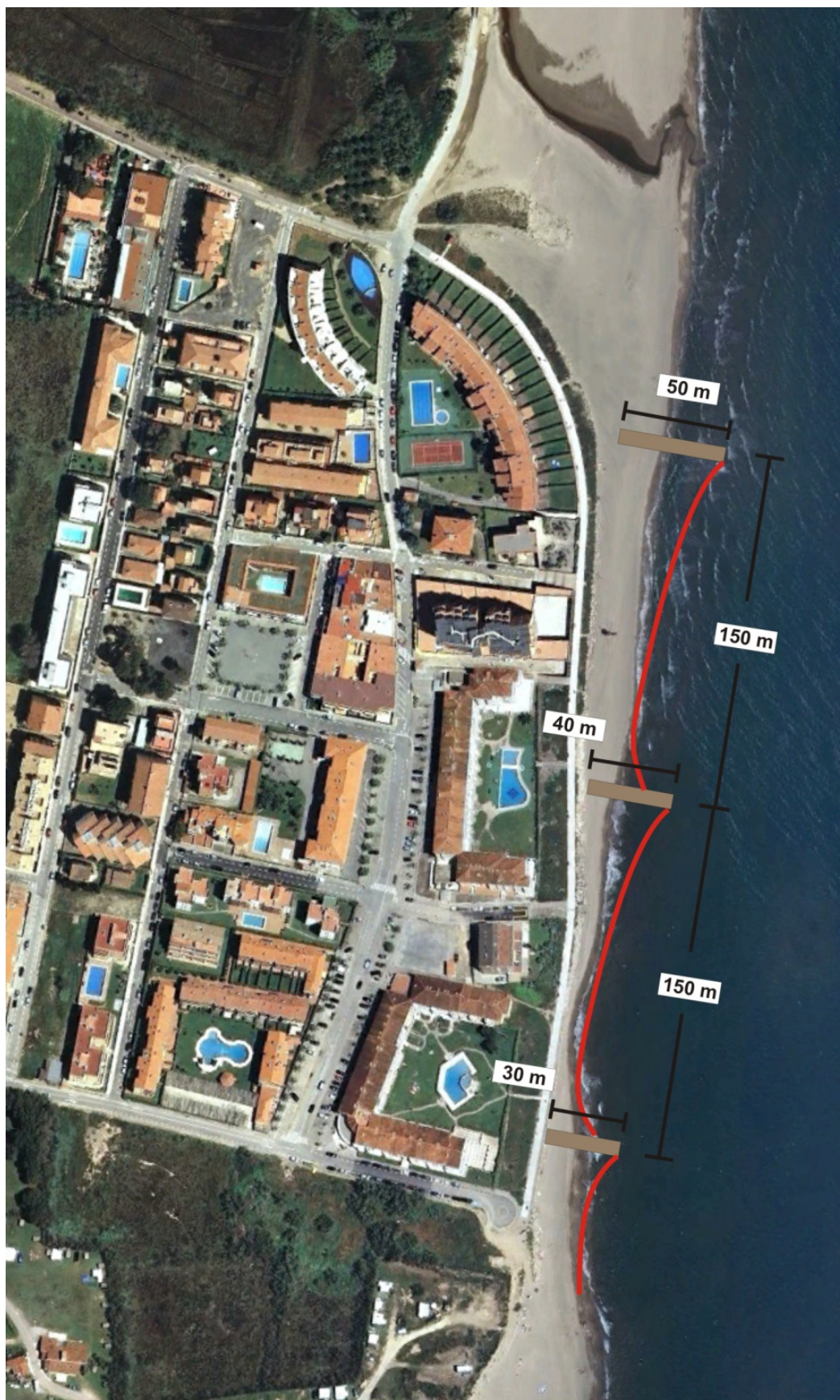
Figura 57 – Propuesta de protección de la erosión mediante 3 espigones de pequeñas dimensiones y perpendiculares a la línea de costa. Se indican dimensiones y predicción de futura línea de playa.
