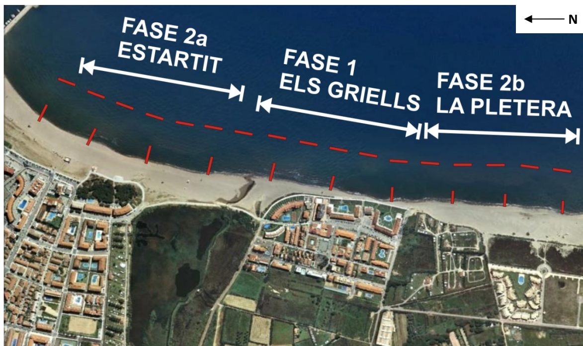
Figura 65 – Detalle de la propuesta de protección global de todo el frente litoral de l'Estartit, del dique de Garbí a La Pleta. Se indican las dos posibles soluciones a la vez (diques exentos y espigones perpendiculares) así como las dos fases constructivas propuestas. La primera, de Els Griells de carácter urgente, la segunda, de l'Estartit y La Pleta, prioritarias.
