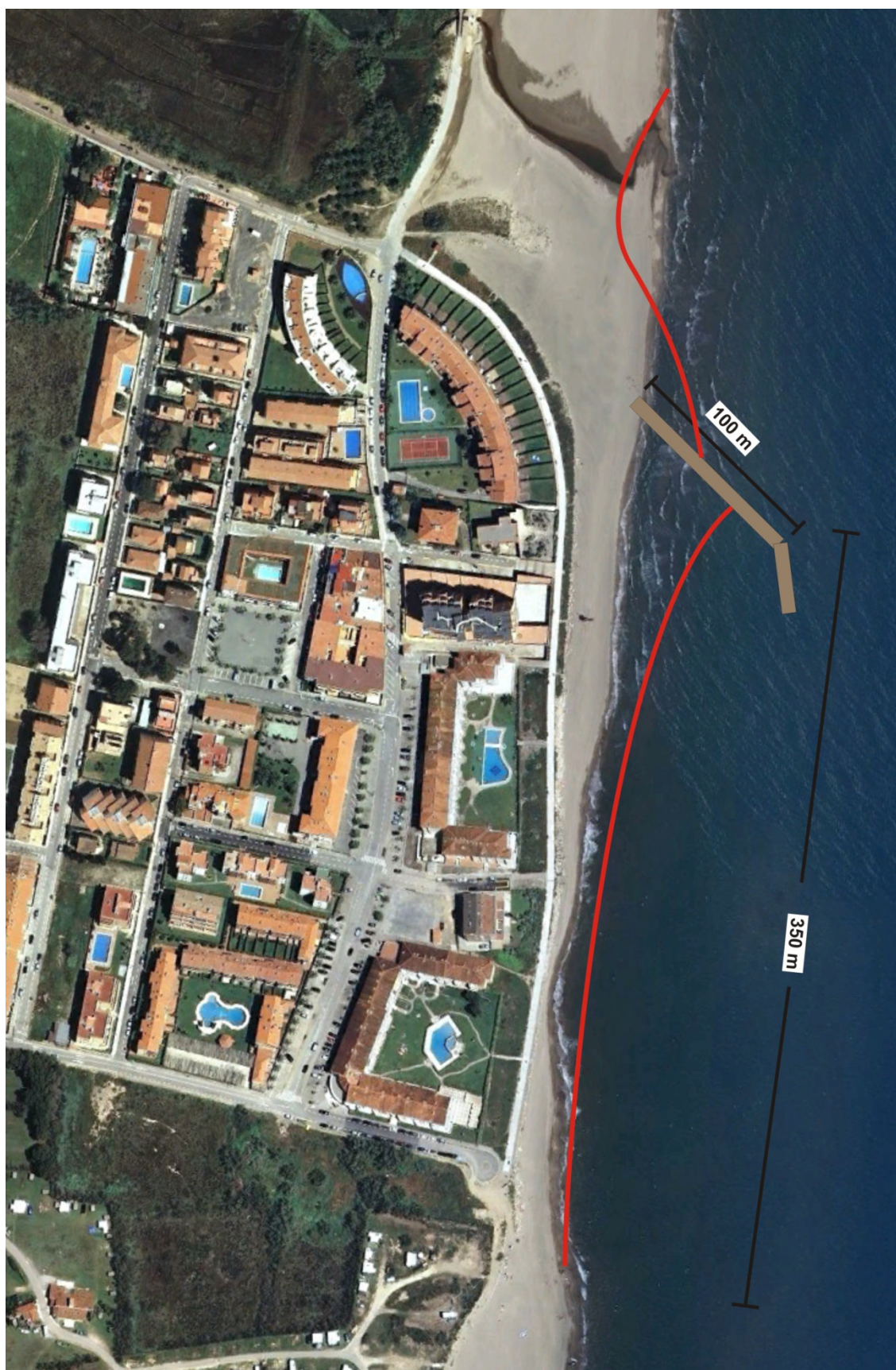
Figura 56 – Propuesta de protección de la erosión mediante espigón semiperpendicular a la línea de costa. Se indican dimensiones y predicción de futura línea de playa.
