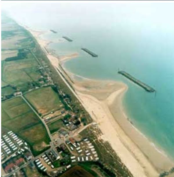
Figura 52 – Aspecto de una serie de espigones exentos, paralelos a la costa en Sea Palling (Norfolk, Reino Unido).
