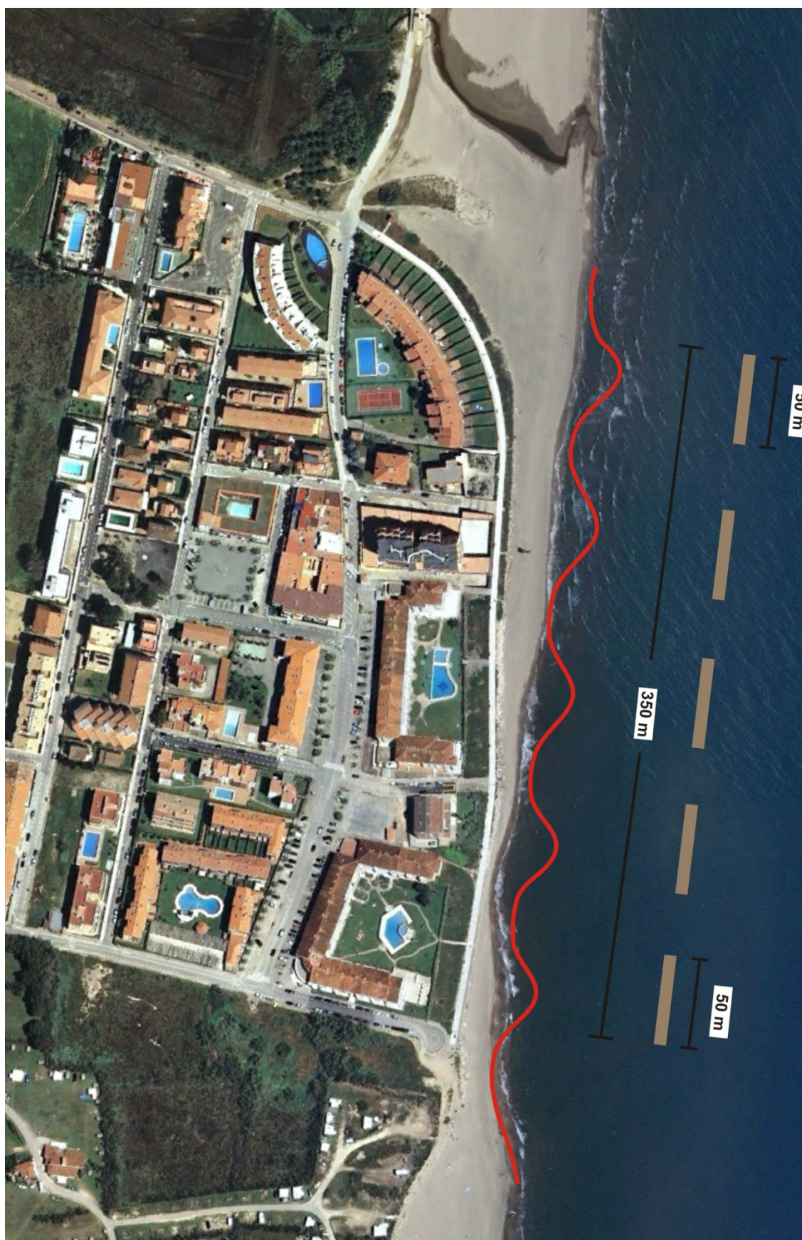
Figura 59 – Propuesta de protección de la erosión mediante 5 espigones exentos de la costa. Se indican dimensiones y predicción de futura línea de playa.
