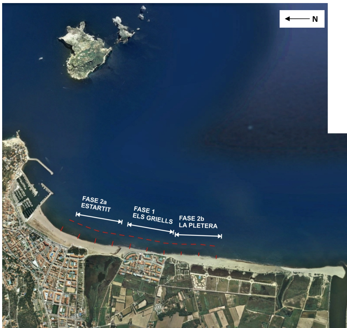
Figura 64 – Propuesta de protección global de todo el frente litoral de l'Estartit, del dique de Garbí a La Pletera. Se indican las dos posibles soluciones a la vez y las dos fases constructivas propuestas.
